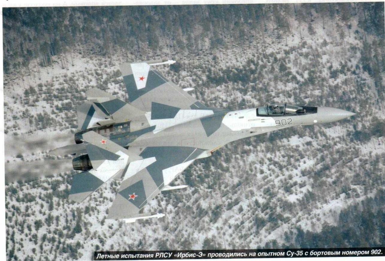
Летные испытания РЛСУ «Ирбис-Э» проводились на опытном Су-35 с бортовым номером 902.
