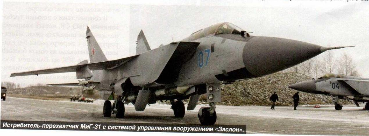
Истребитель-перехватчик МиГ-31 с системой управления вооружением «Заслон».
