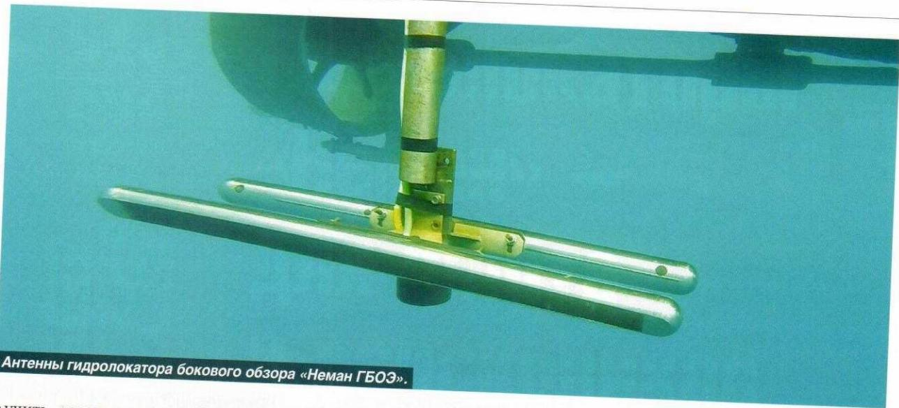
*Антенны гидролокатора бокового обзора «Неман ГБОЗ».*
